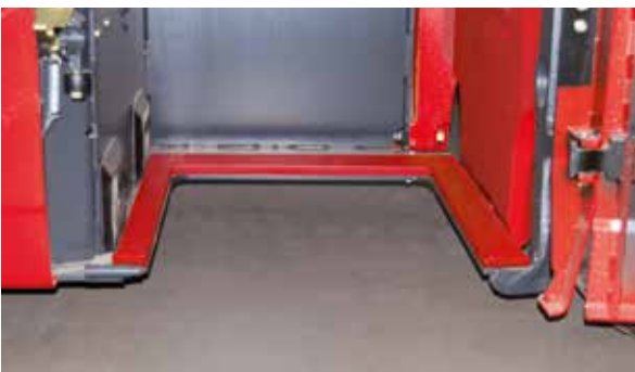
3. Die geladene Ersatzbatterie kann sofort wieder eingesetzt werden. (Der Einlegerahmen schafft zusätzliche Bodenfreiheit.)
