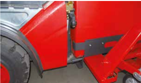
1. Hubwagen an der Führungsschiene unter der Batterie einfahren.
