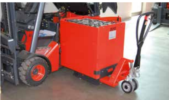
2. Die Batterie mit dem Hubwagen aus dem Stapler ziehen.
