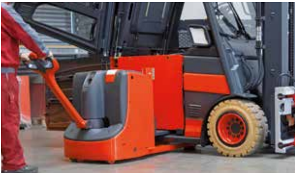
1. Entladene Batterie mit dem Hubwagen herausfahren.
