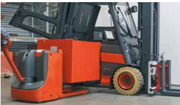
3. Die geladene Ersatzbatterie in den Stapler einsetzen.
