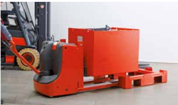
2. Batterie auf der Plattform absetzen.
