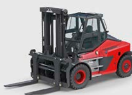
HT100 - HT180 Schwerlaststapler, hydrodynamischer Antrieb Tragfähigkeit: 10,0 t - 18,0 t
