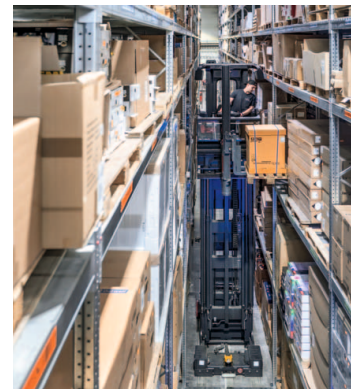
Das Linde-Assistenzsystem Dynamic Reach Control stabilisiert die K-Geräte seitlich beim Ausschleiben der Last.
