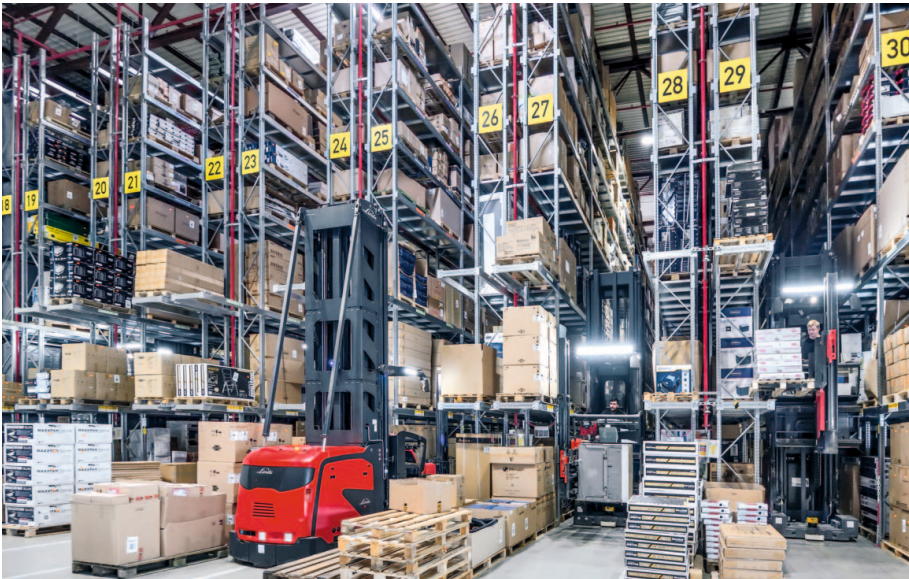
Die operativen Prozesse laufen – und die Logistik bleibt anpassungsfähig: Dank der Linde K-Geräte mit Active Stability Control kommt die Wagner eCommerce Group in ihrem neuen Schmalganglager gänzlich ohne teure Spezialböden aus.
