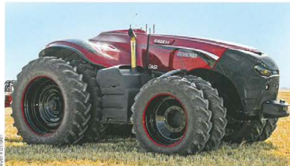
Der autonome Case IH Magnum verzichtet auf eine Kabine.
