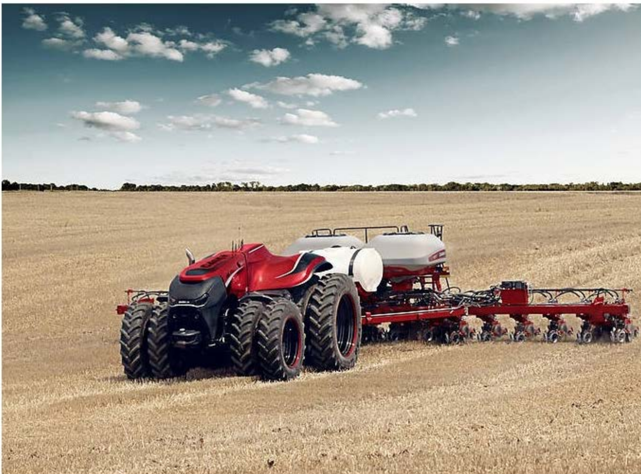
Case IH und das Innovationsteam von CNH Industrial stützten sich bei der Entwicklung des autonomen Traktorkonzepts auf das bestehende Case IH Magnum Modell.
