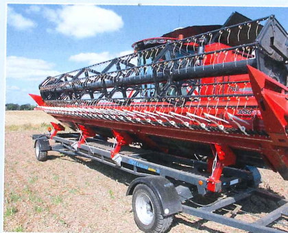
Beim Ablegen hilft ein Peilstab, nur neigen die kurzen hinteren Auflagen zum Verklemmen.
