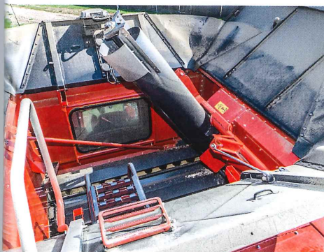
Nach unserer Messung fasst der Korntank knapp 10 m 3 .
