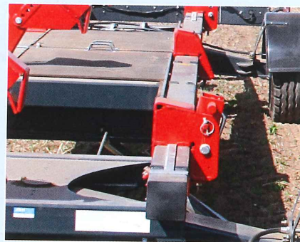
Schönes Detail für mehr Bewegungsfreiheit: die wegklappbare Bolzenverriegelung.
