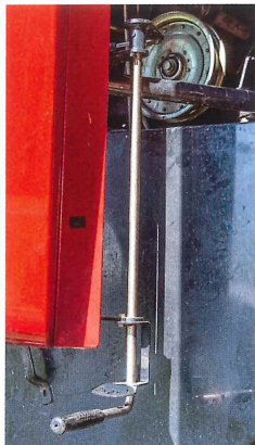
Gut erreichbar: Dreigang-Getriebe für Rotorantrieb (oben), Leitblechverstellung für Häcksler (oben rechts) und Zweistufenantrieb des Häckselrotors (rechts).
