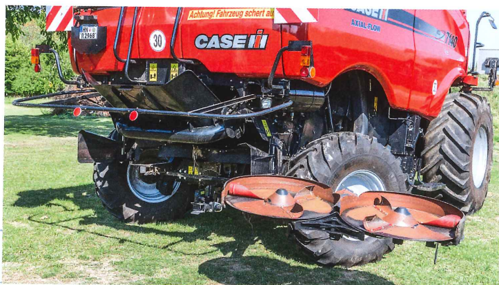
Der komplette Spreuverteiler lässt sich werkzeuglos weg-schwenken. Das verbessert die Zugänglichkeit enorm – nicht nur zur neuen „X-Flow“-Reinigung.
