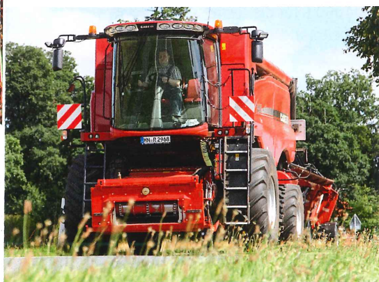
Mit 710er Bereifung soll die Transportbreite jetzt 3,49 m betragen (im Test noch 3,62 m).
