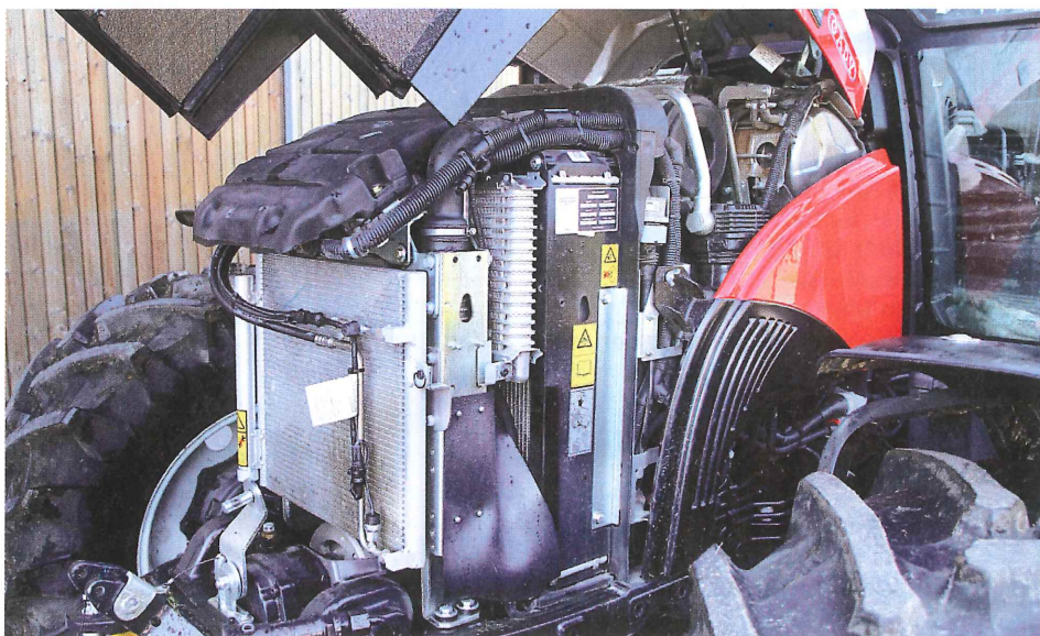
Der FPT-Motor mit DOC und DPF erfüllt die Abgasstufe 3B.
