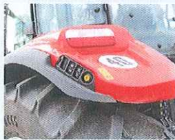
Komfortabel: Ventil, Hubwerk und Zapfwelle können extern bedient werden.
