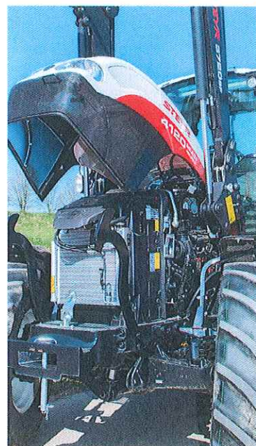
Der FPT-Vierzylinder F5C mit 3,4 l Hubraum erfüllt die Abgasstufe IV ohne Partikelfilter. Leistung, Verbrauch und vor allem die Laufruhe sind super!
