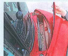
Zu dreckig: Das Kabinenfilter sitzt auf dem Kotflügel genau im Staubbereich.
