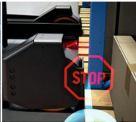
Der Linde Rack Protection Sensor wird ab einer Fahrgeschwindigkeit von weniger als 5 km/h aktiv. Erkennt er innerhalb eines Radius von 5 Metern ein Hindernis, bremst der RPS das Gerät proportional zur Fahrgeschwindigkeit ab und verhindert damit Beschädigungen an Regal und Waren.
