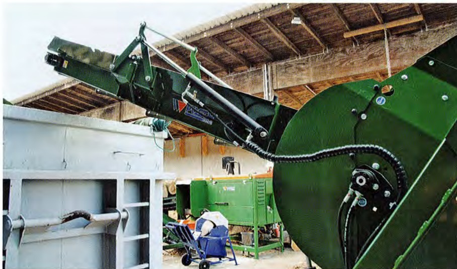
Das klappbare Förderband ist oben angebaut und kommt bei 2,50 Meter Länge auf eine Überlappungshöhe von drei Meter.
