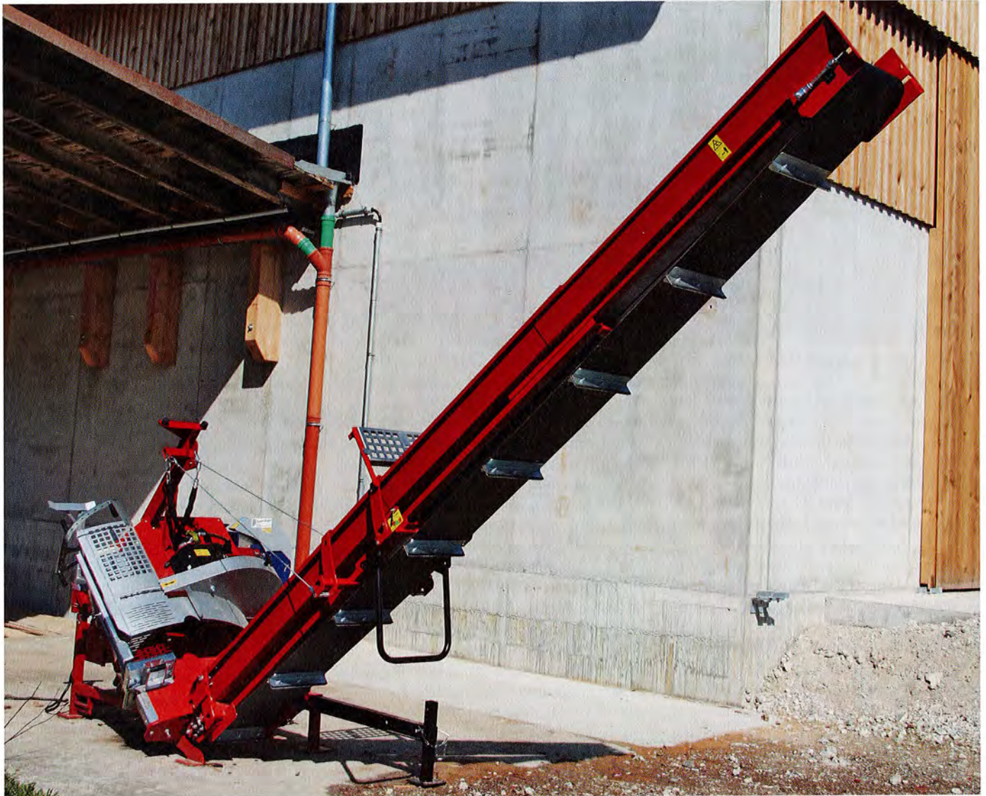
Mit dem fünf Meter langen Förderband lassen sich Anhänger oder Container bis drei Meter Höhe laden.
