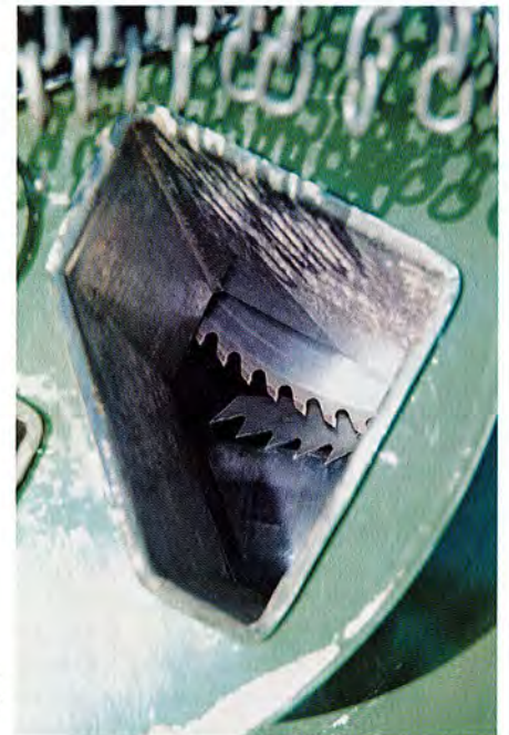
Der Niederhalter vermeidet das Klemmen des Holzes.
