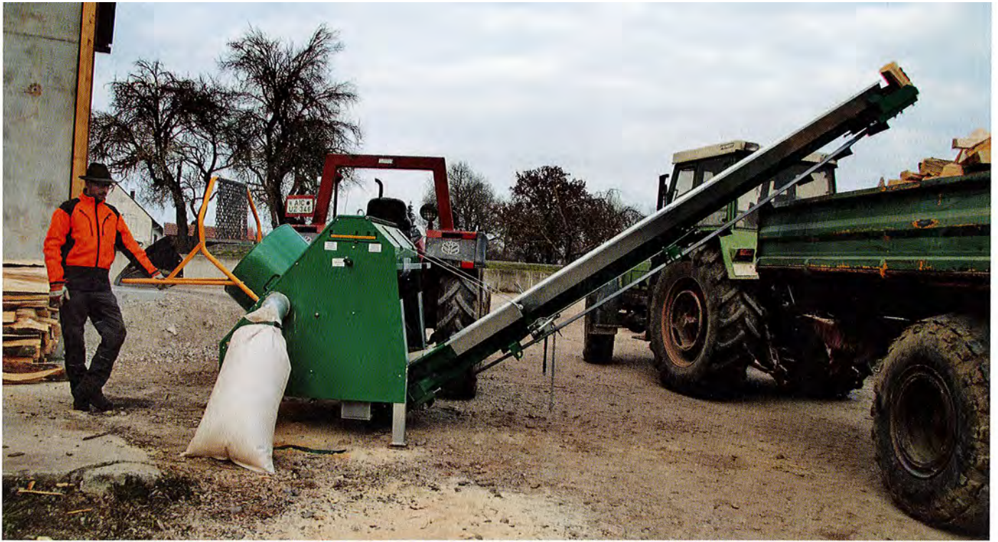
Mit dem 4,50 Meter langen Förderband wird eine Überladehöhe von 3,20 Meter erreicht.
