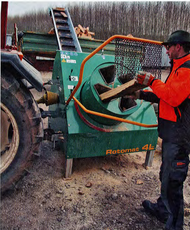
Die vier Kammern drehen sich gegen den Uhrzeigersinn. Nur leere Kammern dürfen befüllt werden. Abschnitte von 20 bis 50 Zentimeter sind möglich.
