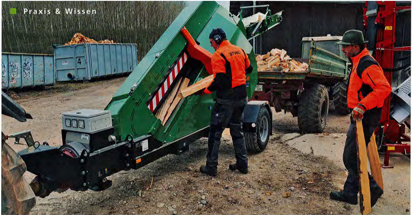
Bei der Säge AutoCut von Posch wird das Holz in eine schräge Lade eingelegt und von den Mitnehmern zum Sägeblatt geführt.
