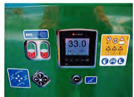
Taster für die Bedienung von Säge und Förderband. Mit dem kleinen Touchscreen kann man die Schnittlängen und die Toleranz vorwählen.
