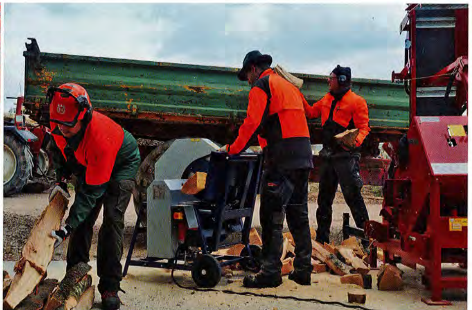
Die Wippkreissäge ist die einfachste Art Meterholz abzulängen. Ein 7,5-kW-E-Motor treibt das Sägeblatt über einen Doppelkeilriemen an. Ohne Förderband ist auch noch ein Abnehmer vonnöten.
