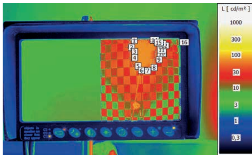
Bild 8: Blooming-Test, Gesamtfläche des Bilds auf dem Monitor: 280500 Pixel, überstrahlte Fläche = 30820 Pixel, d. h. 10,1 %
