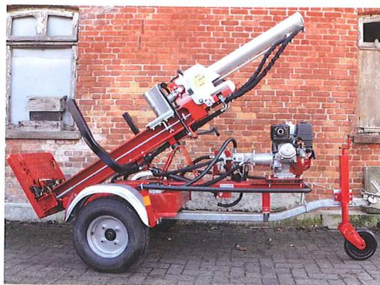
*In Transportstellung: In dieser Lage wird der Spalter gezogen, zusätzlich kann der Zylinder etwa einen Meter weiter eingezogen werden.*
