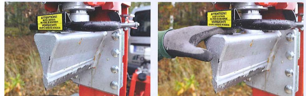
Klemmgefahr: Beim Hochfahren stoppt der Keil direkt unterhalb eines Schutzbügels (links). Auch wenn eine Hand dort eigentlich nichts zu suchen hat, können die Finger zwar nicht gequetscht, aber eingeklemmt werden (rechts).
