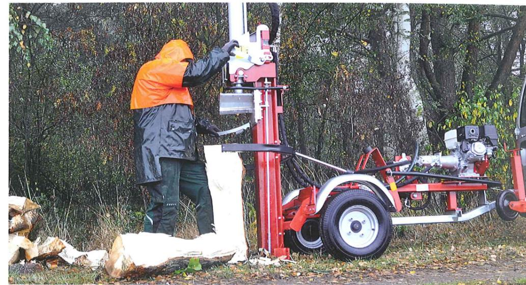
Mit über 16 Tonnen Spaltdruck bricht der Meterholzspalter auch starkes Holz mühelos auf. Die Fixierung der Stämme mit der Haltekralle funktioniert jedoch nur, wenn das Holz unmittelbar an der Spaltsäule steht. Abstehende oder etwas kürzere Stücke können die Greifzacken (unten links) nicht festhalten. Solches Holz muß deshalb mit dem Knie gestützt werden (oben). An den seitlichen Stammstützen befindet sich jeweils eine Sappiehalterung (unten rechts). Fotos: Riemann
