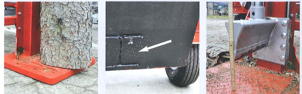
Die mittig geriffelte Bodenplatte ist äußerst massiv, aber leider nicht angeschrägt (links), wodurch das Aufstellen des Holzes einfacher wäre. Für mehr Festigkeit ist die Spaltsäule von unten zusätzlich verschweißt (Pfeil Mitte). Der Restabstand des Spaltkeils zur Bodenplatte beträgt etwa 14 Zentimeter (rechts), so daß auch ein versehentlich hier abgestellter Fuß unverletzt bleibt. Das entspricht den Sicherheitsnormen für Holzspalter.
