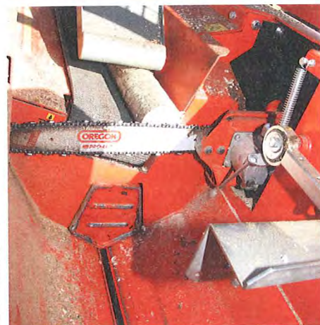
Der Stempel wird stabil geführt und arbeitet 2 Geschwindigkeiten mit 5 und 8 t Spaltkraft.
