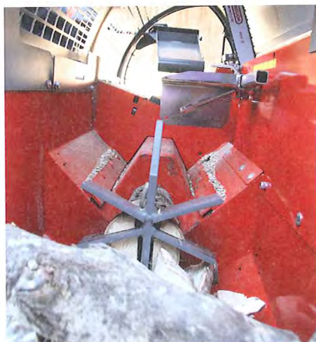
Der Stempel wird zusätzlich durch zwei Eisen im Kanal geführt. Mehr Kraft wäre gut.
