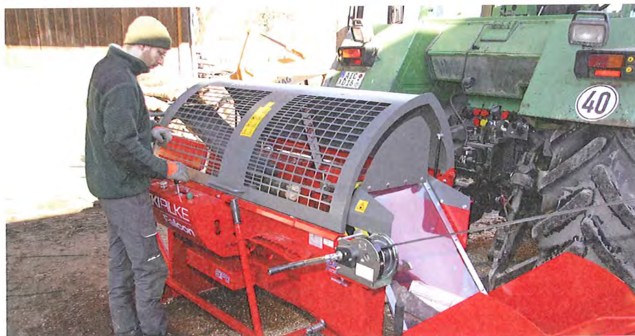
Die Falcon kommt mit der einfacheren Bedienung, vor allem ohne hydraulische Spaltkreuzverstellung. Die Säge ist zur Wartung gut zugänglich, ähnlich der Easy 38.
