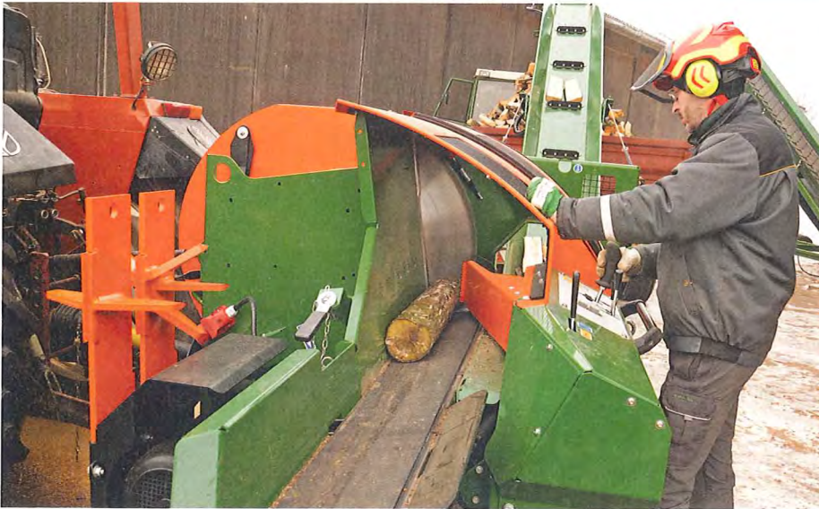
Teuer, aber gut. Die Spaltfix S-360 ist schnell und kräftig. Die Bedienung geht auch ohne Automatik mit dem Joystick flott von der Hand. Für eine Kreissäge ist die S-360 erstaunlich leise.
