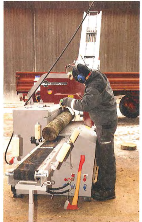
Handwerk: Die Bedienung der KSA 350 erfolgt mechanisch. Ein Hebel aktiviert den Niederhalter, der zweite führt die Säge durch das Holz.
