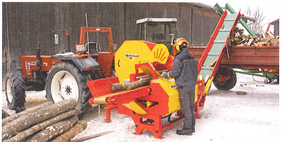
Die Rabaud Xylog 390 ist robust gebaut. Auf eine elektrische Steuerung wird komplett verzichtet. Etwas gewöhnungsbedürftig ist die Zweihandbedienung für Zuführband und Säge.
