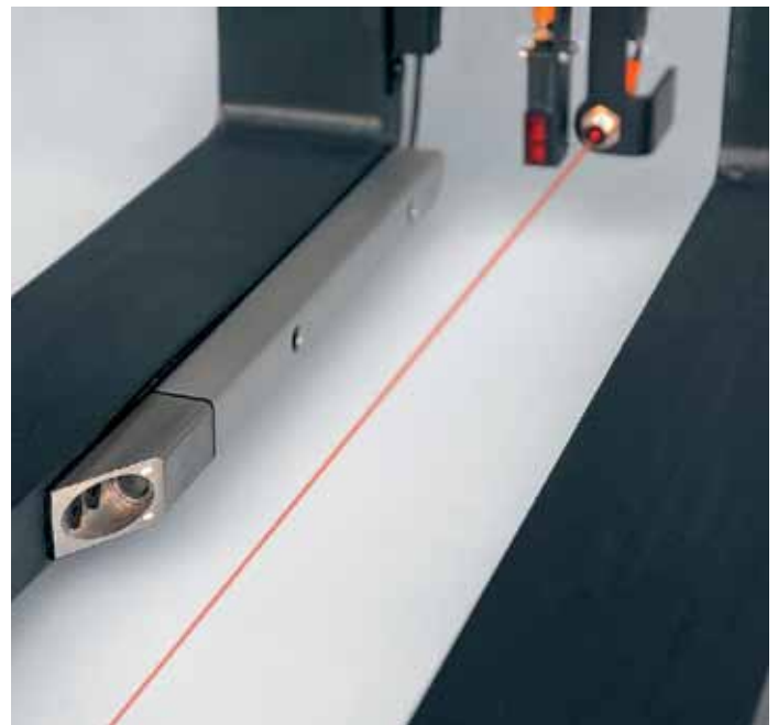
Positionierhilfe Ein Laserpointer unterstützt Sie bei der schnellen Platzierung der Last.
