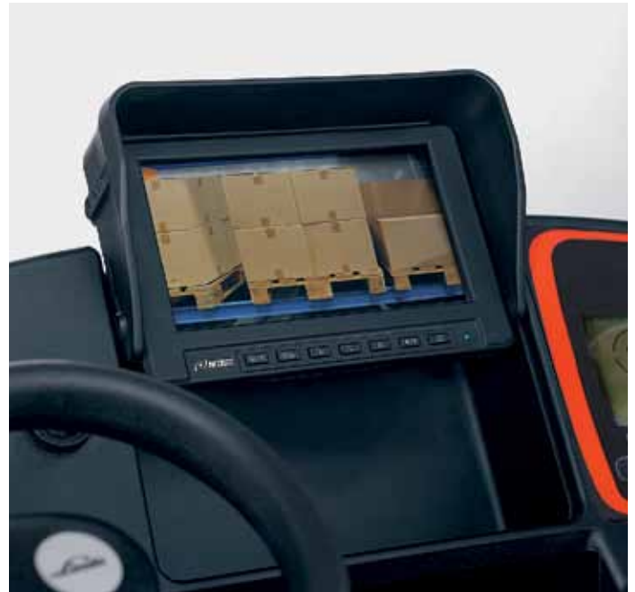
Videokamera Optimales Bild für sicheres Palettenhandling in größeren Hubhöhen.
