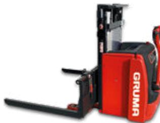
T 20 mit Scherenhubtisch und Zusatzhydraulik
