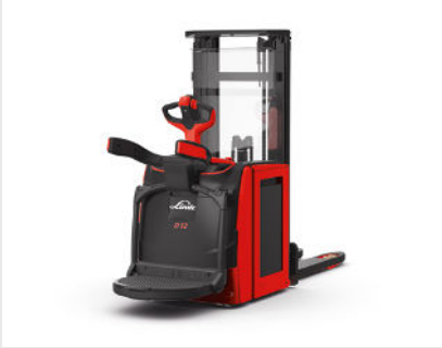
Klappbare Seitenbügel schützen den Bediener
