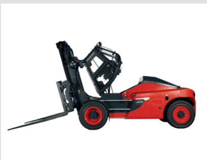
Der Motorzugang erfolgt durch die kippbare Kabine
