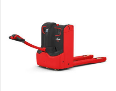
Lange Deichsel und tiefgezogenes Chassis
