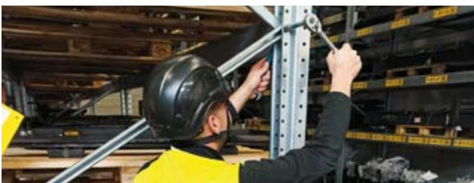
Auch Regale müssen nach der Betriebssicherheitsverordnung jährlich geprüft werden. Die Regale werden auf Anfahr-schäden, Absenkungen und mangelhafte Befestigungen untersucht.
