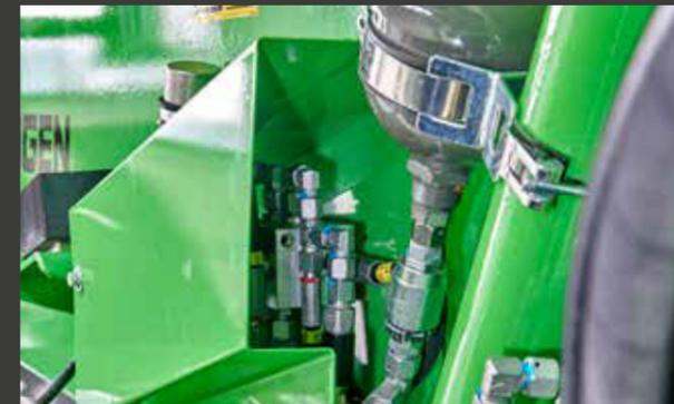
4 Wichtige Ventile und Elektrik sind geschützt und von außen zugänglich, selbst bei gesenktem Teleskopausleger.
