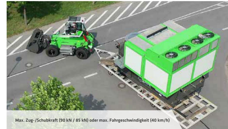
Max. Zug-/Schubkraft (90 kN / 85 kN) oder max. Fahrgeschwindigkeit (40 km/h)
