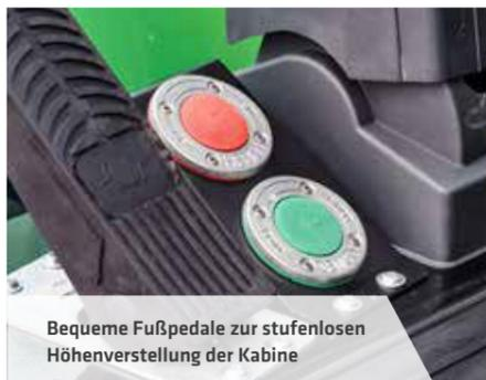
Bequeme Fußpedale zur stufenlosen Höhenverstellung der Kabine
