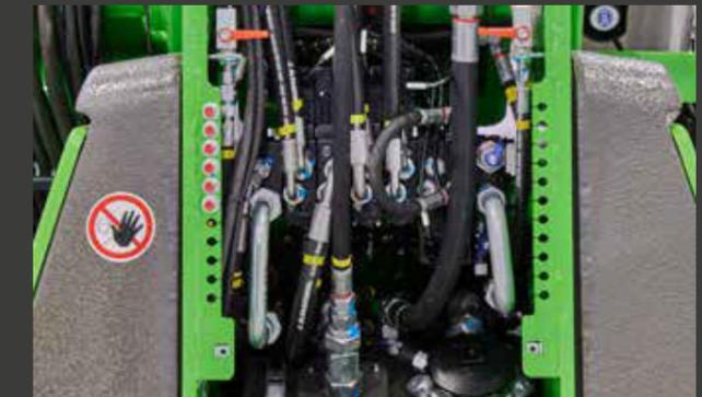
6 Bestmöglicher Zugang zum Hauptsteuerblock, Hydrauliköltank und Rücklauffilter.
