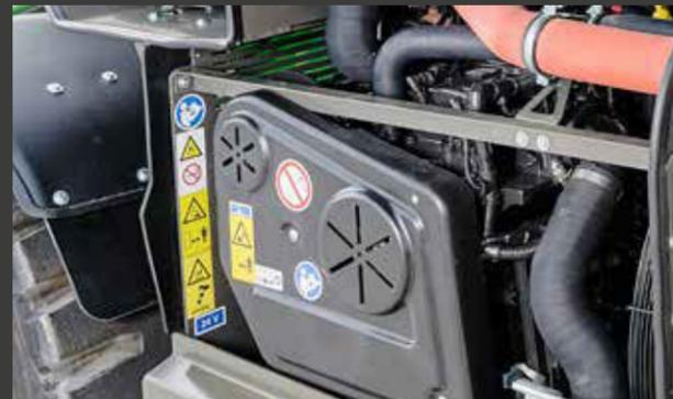
1 Einfacher Zugang zu allen Service-Punkten dank quer eingebautem Motor.
