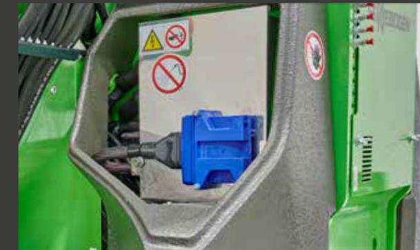
5 Optimale Zugänglichkeit zum Hauptsicherungskasten mit integriertem Übersichtsplan.
