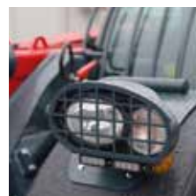
Schutzgitter an Kabine und Scheinwerfern
