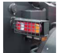
Schutzgitter an Kabine und Scheinwerfern
